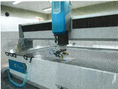
Systém FLOW Mach4c je portálové konstrukce. Výhodou je vysoká stabilita přesnosti pojazdového systému. Stroj má pracovní lamelový stůl o rozloze 2 x 4m.
