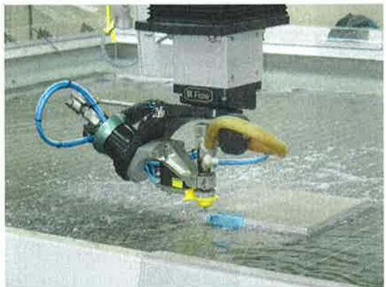
Stroj při řezání testovacího vzorku s úkosy na hliníkové desce o síle 30 mm. Hmotnost desky umožňuje opracovávat desku jako volně položenou na lamelovém pracovním stole.
