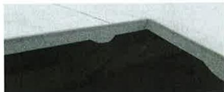
Řezaný úkos na 80 mm silné desce dřeva.
